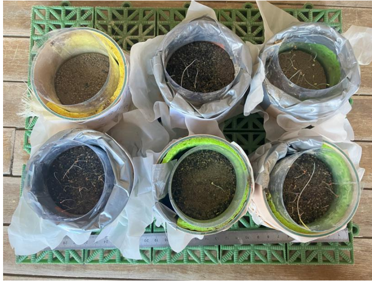
Application de cinq cycles d'humidification-séchage
